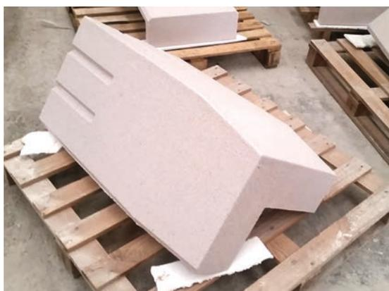
Procedemos a llenar los moldes con **hormigón hidrofugado en masa** y colorante rosado para otorgarle la tonalidad deseada. El acabado es en micrograno blanco raspado.
